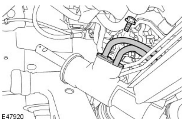
7. 从动力转向齿轮上断开压力管。
