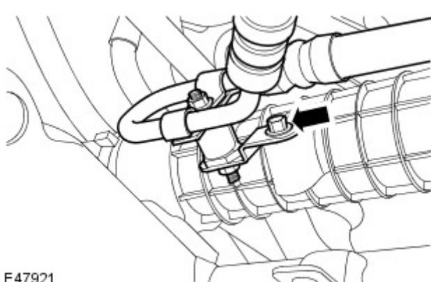
8. 卸下转向齿轮高压管。
